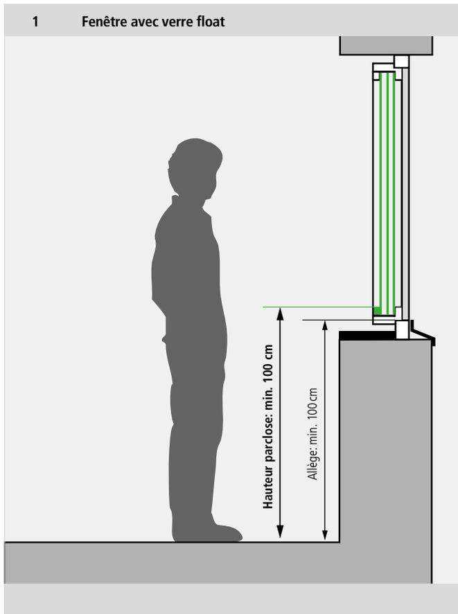
Le **verre float** peut être utilisé si, pour un **vitrage fixe**, l'arête supérieure de la parclose inférieure se situe à au moins 1,0 m au-dessus de la surface praticable. La protection antichute est assurée par l'allège.
